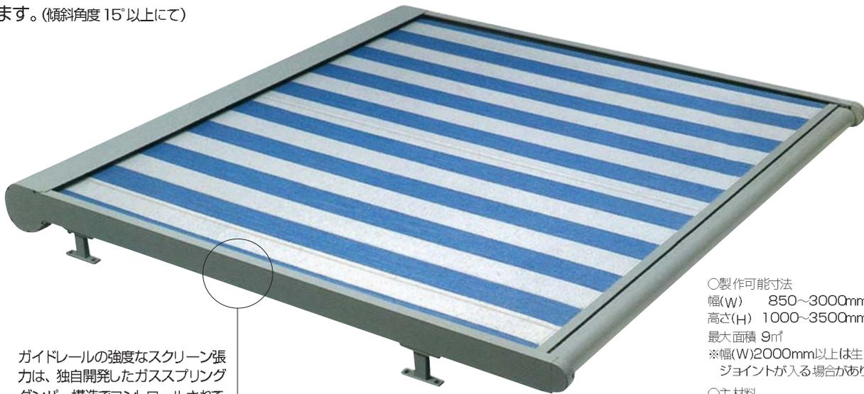
ガイドレールの強度なスクリーン張力は、独自開発したガススプリングダンパー構造でコントロールされています。また15m/secの風に耐えられるよう設計されています。
