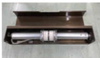
モータの劣化及び回転軸の老化
